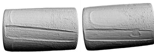
Рис. 1. Зображення 3D-моделей стріляних куль зі слідами нарізів каналів ствола, виготовлені засобами програмно-апаратного комплексу BalScan
