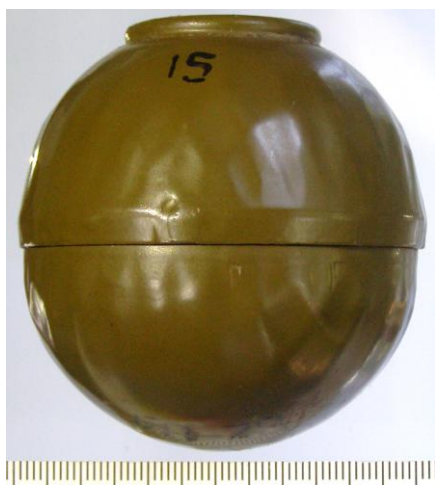
Рис. 1. Корпус ручної гранати РГН.
