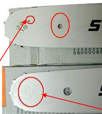
Зображення 5. Відмінність оригінальної шини бензопили марки «STIHL MS 270» від її копії.
