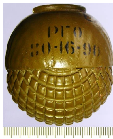
Рис. 2. Корпус ручної гранати РГО.
